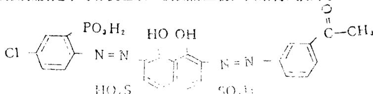
该试剂在酸性溶液中呈紫红色，与稀土离子生成兰色或紫色的配合物。它既可用于球墨铸铁和低合金钢中微量稀土总量的光度测定 ( $7$ )，又能与间乙酰基偶氮氯磷联用直接光度测定稀土总量和轻重稀土分量 ( $10$ )，是稀土总量较理想的显色剂；以后还发现该试剂可用于铈 ( $\text{VI}$ ) ( $11$ )、钙 ( $12$ ) 等元素的光度测定。但该试剂与稀土元素镧的配合反应未见详细报导，有必要对该显色剂在水溶液中的离解作用、及其与稀土离子  $\text{La}^{3+}$  的配合反应、组成、稳定性、动力学特征作进一步研究。
