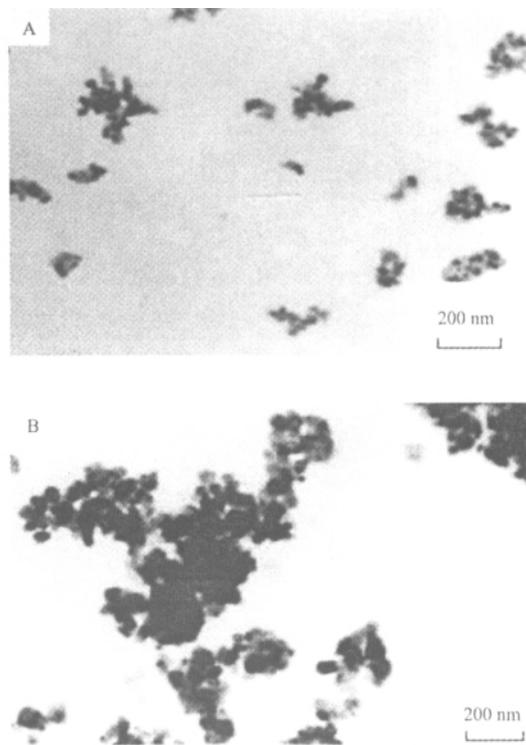
图 7 不同焙烧温度后高分子前驱体法制备样品的 TEM 照片
