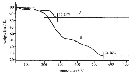
图 4 两种方法制备的催化剂干凝粉的热重(TG)图
