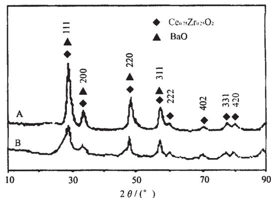
图 1 两种方法制备的催化剂粉体的 XRD 谱图
