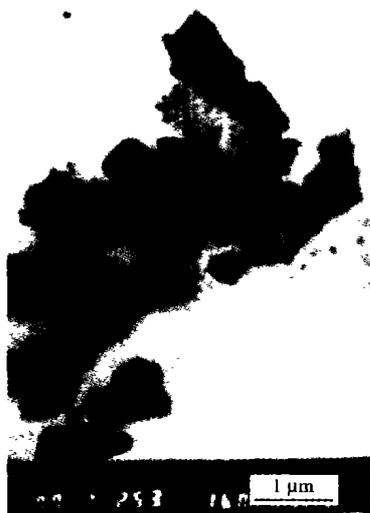
图 3 超细  $K_2La_2Ti_3O_{10}$  样品的 TEM 照片Fig. 3 TEM micrograph of the ultrafine  $K_2La_2Ti_3O_{10}$  sample
