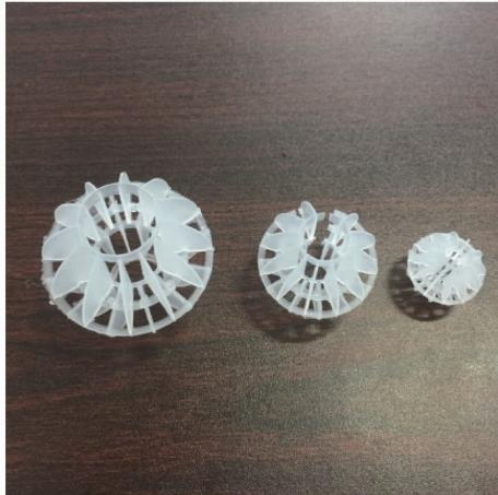
图 9 不同直径浮球对  $\text{COD}_{\text{Cr}}$  变化的影响及浮球实物图
